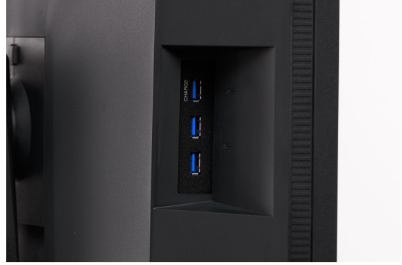
Ports USB 3.0 en aval : Celui du haut avec fonction de chargement de la batterie
